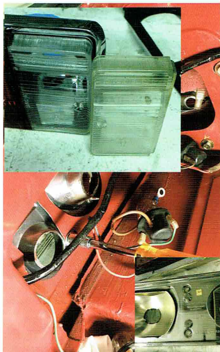
1. Demonteren, schoon en vuil glas en de reflector waar de aluminiumfolie nog op moet.
