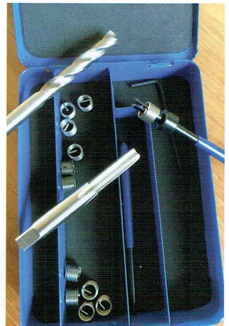
foto 8 Reparatieset 5/16x24 schroefdraad
